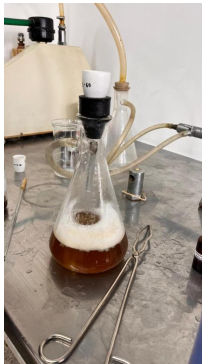
Figura 19. Proceso de filtración con agua caliente.
