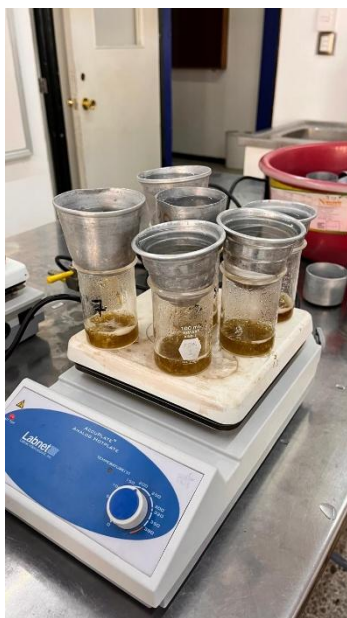
Figura 16. Muestras hirviendo con detergente neutro para ser filtradas.
