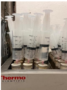
Figura 10. Jeringas colocadas para capturar los gases.
