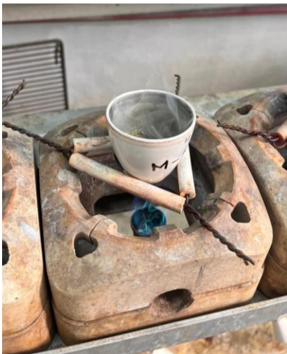
Figura 12. Incineración de la muestra para cenizas.
