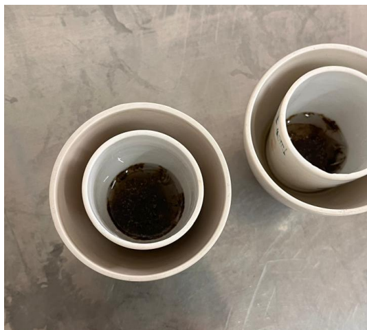
Figura 18. Residuo de FDA sumergido en solución de H 2 SO 4 al 72 %.
