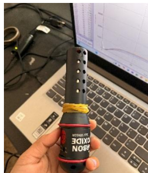
Figura 11. Sensor de dióxido de carbono Vernier Or.
