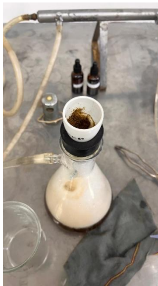
Figura 17. Proceso de filtración después de la hervor durante 60 min.
