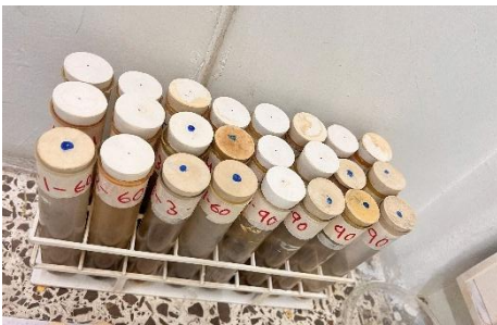
Figura 8. Tubos de digestibilidad preparados con la muestra y tapados con taponés de goma.
