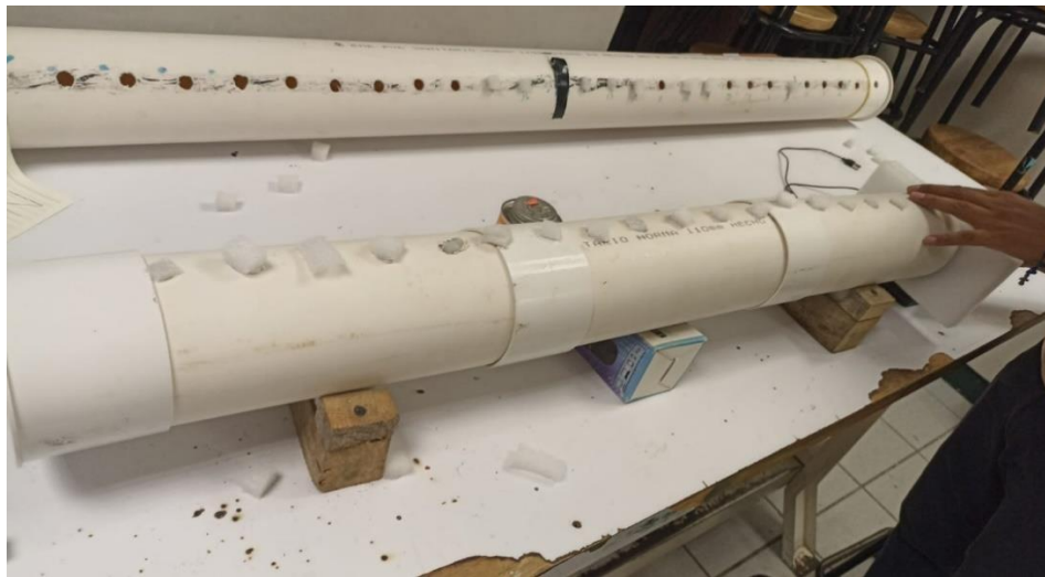
Figura 25. Colocación de espumas en tubo Kundt para evitar pérdidas de presión e intensidad. Fuente: El autor
