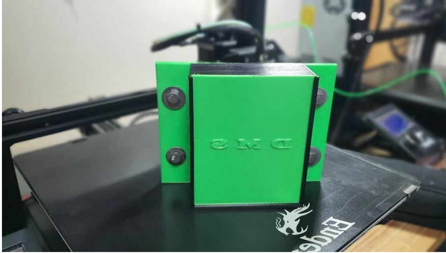
Figura 36. Diseño impreso de carcasa en PLA de prototipo. (vista frontal) Fuente: El autor
