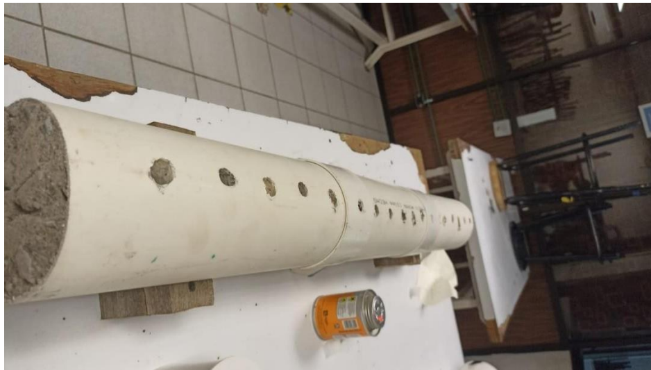
Figura 24. Representación de tubo de Kundt relleno de concreto con espaciados de aire. Fuente: El autor.
