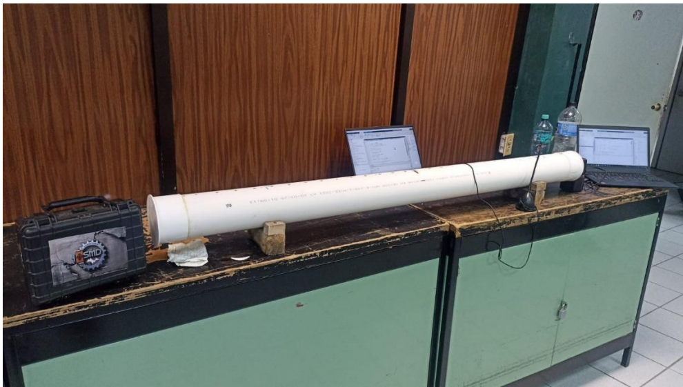
Figura 23. Representación de tubo Kundt para estudio de ondas senoidales en diferentes medios de propagación (agua y aire). Fuente: El autor.
