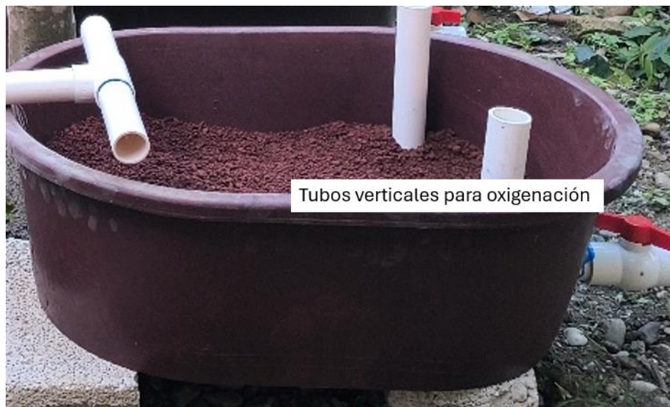
Figura 3.15. contenedor que presenta la estructura de las tuberías de ingreso del agua y la zona de captación y oxigenación en la parte inferior derecha.
