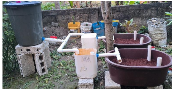
Figura 3.14. sistema mesocosmos para el tratamiento experimental de aguas residuales antes de la plantación.
