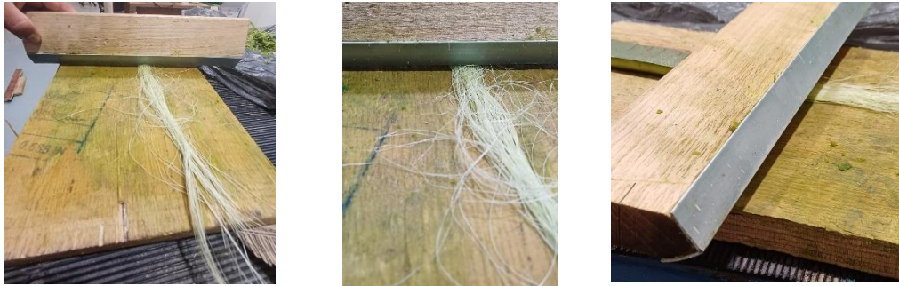
Figura 29 Pruebas de desfibrado de ixtle a través de los materiales propuestos. Fuente propia.
