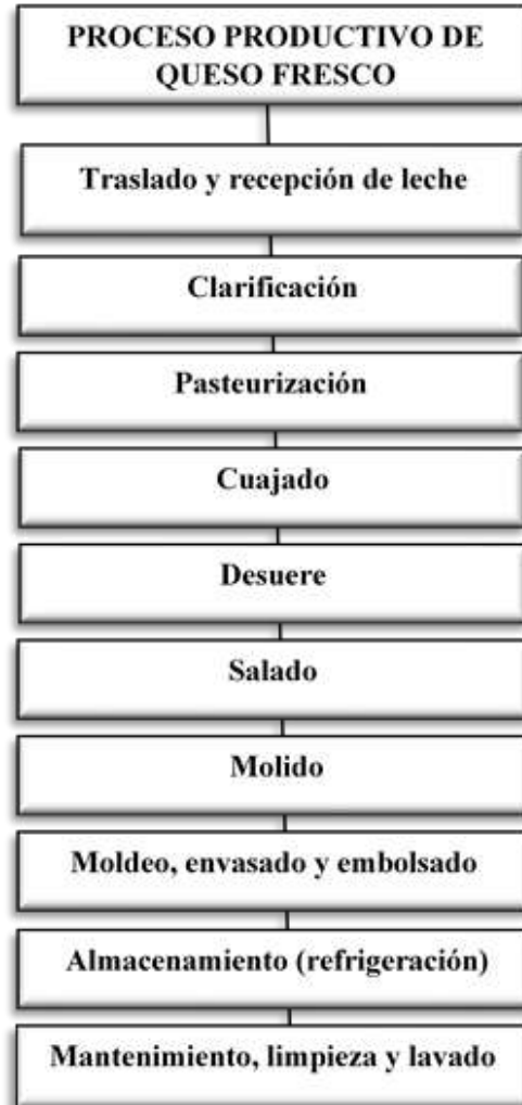
Figura 3.10 Diagrama de flujo del sistema en estudio (de la puerta a la puerta)
