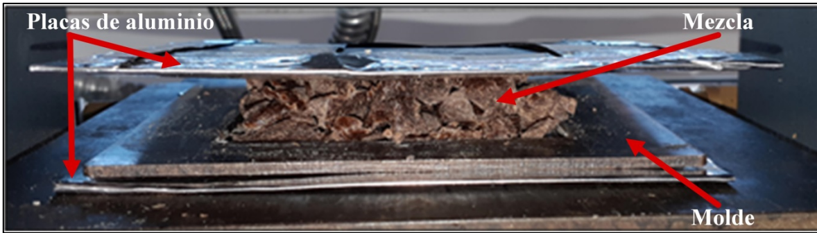
Figura 31 Colocación de la mezcla en el molde. Fuente: El autor, Altamira, Tamaulipas, 2019.
