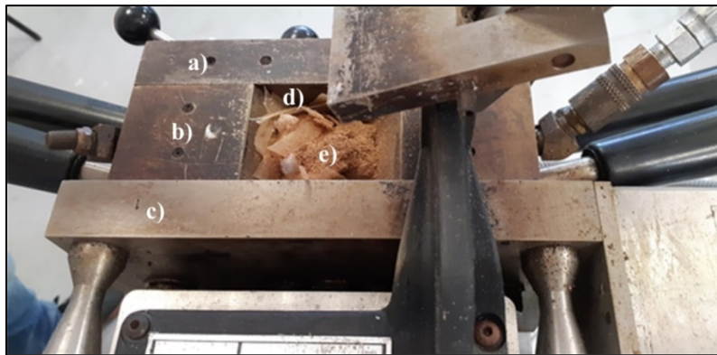
Figura 23 Incorporación de los materiales al Reómetro, a) Zona de Calentamiento 1, b) Zona de Calentamiento 2, c) Zona de Calentamiento 3, d) Cámara de mezclado y e) Materiales. Fuente: El autor, Altamira, Tamaulipas, 2019.
