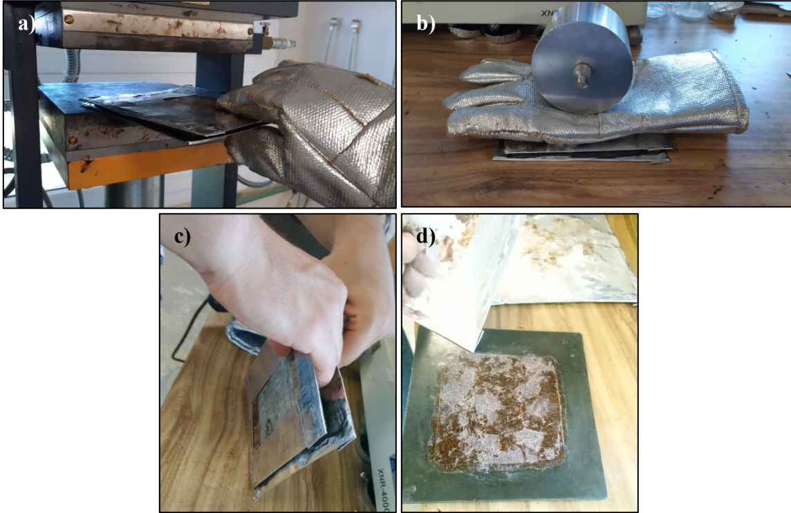
Figura 33 a) Retiro de la muestra, b) Colocación de peso, c) Separación de las placas de aluminio y d) Desmolde de la muestra. Fuente: El autor, Altamira, Tamaulipas, 2019.
