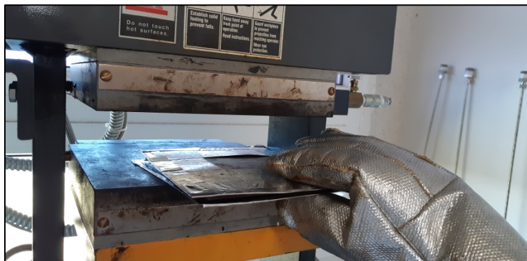
Figura 32 Introducción de la mezcla a la prensa mecánica Dake. Fuente: El autor, Altamira, Tamaulipas, 2019.
