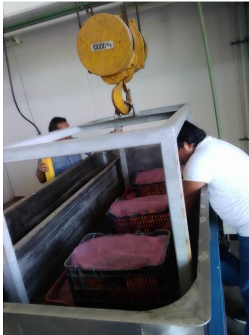
Figura 19 Encanastillado y colocación de sensores en jabs
