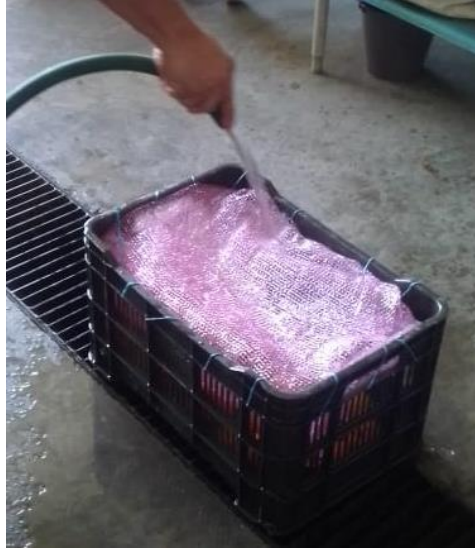
Figura 22 Hidro-enfriado del cítrico
