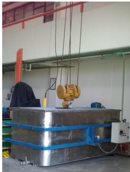
Figura 18 Tina de inicio con tratamiento hidrotérmico
