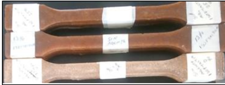
Figura 15. Probeta compósito con 0%,13% y 25% de fibra de cáscara de naranja.
