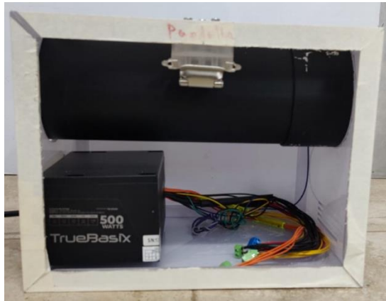
Figura 18.- Instalación del tubo que funge como cámara aislante de la luz del medio ambiente, la fuente de alimentación principal y la bisagra de la pantalla touch. Fuente: Autores
