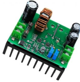
Figura 9. Fuente de poder conmutada boost de 600W. Fuente: Autores
