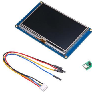
Figura 6. Pantalla táctil TFT marca NEXTION y sus accesorios para programación vía puerto serie. Fuente: Autores Microcontrolador ESP32.
