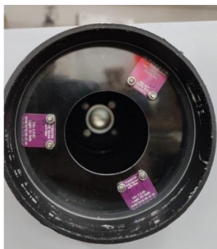
Figura 20.- Instalación de la base soporte de los sensores RGB y de intensidad luminosa, dentro de la cámara de aislamiento de luz del medio ambiente. Fuente: Autores
