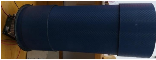
Figura 1. Cámara de aislamiento luminoso. Fuente: Autores
