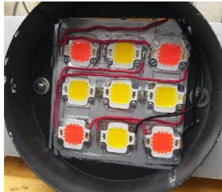
Figura 17.- Instalación la matriz de leds de potencia visto desde el frente de la tapa, lo que será la fuente emisora de luz dentro de la cámara oscura. Fuente: Autores
