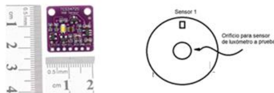
Figura 3. Aspecto y dimensiones del sensor RGB y la colocación en la tapa de medición. Fuente: Autores
