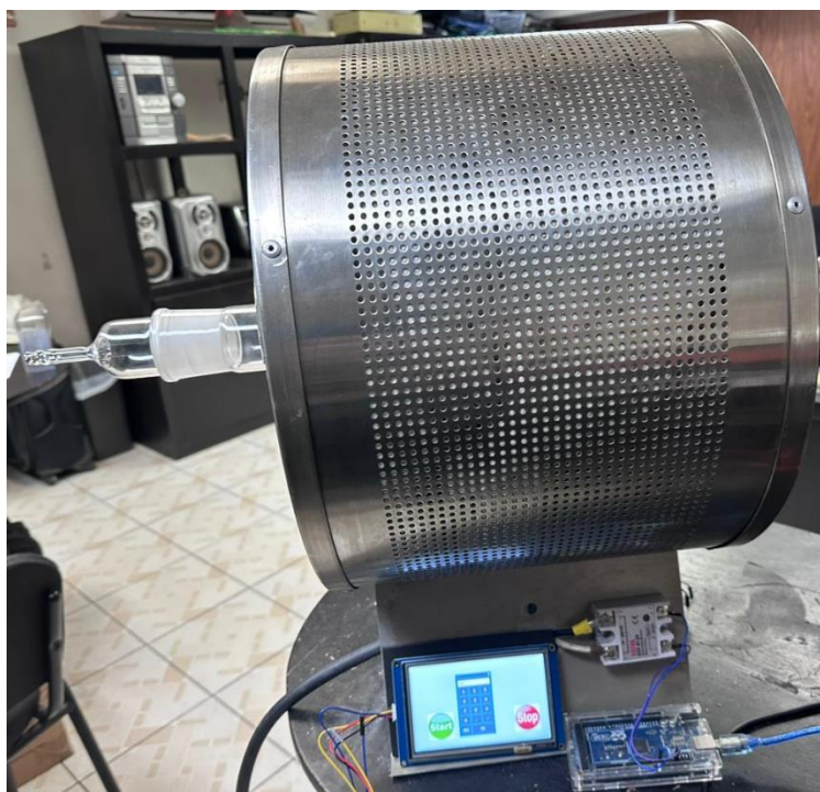
Figura 7.- Forma física del horno junto con la interfaz HMI para el control de lazo cerrado. Fuente: Elaboración propia.
