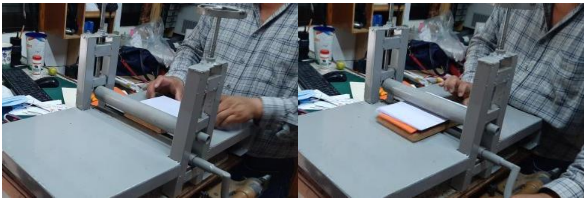
Figura 5. Validación y realización de pruebas con la máquina de corte por parte del empresario.
