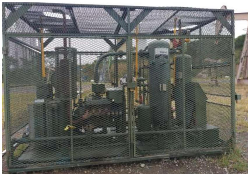
Figura 7 Motocompresor Gas Jack Lift (propiedad compañía de outsourcing).
