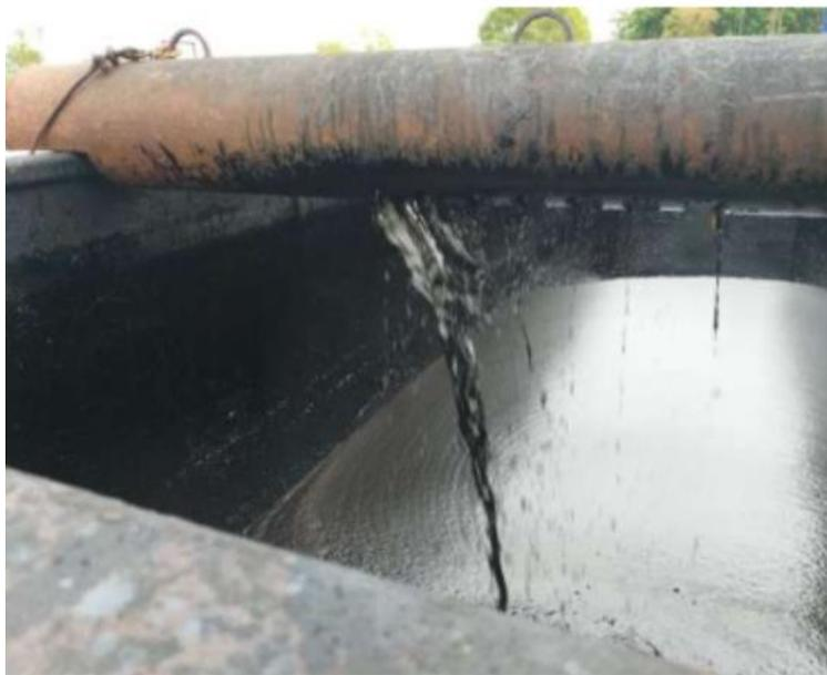
Figura 9 Descarga de hidrocarburo en la presa de medición 30 m<sup>3</sup> (Fuente propia).
