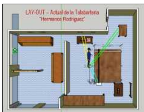
Ilustración 9. Recorrido actual después de la implementación de la estación de trabajo en la talabartería hermanos Rodríguez. Fuente: Propia
