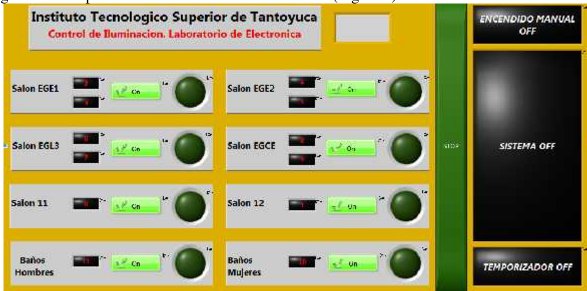
Figura 4. HMI para el control de Iluminación del Laboratorio de Electrónica.
