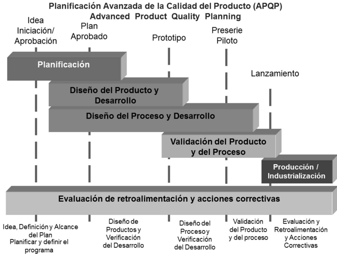
Figura 1. Diseño de la APQP utilizada en el caso de estudio de la investigación
