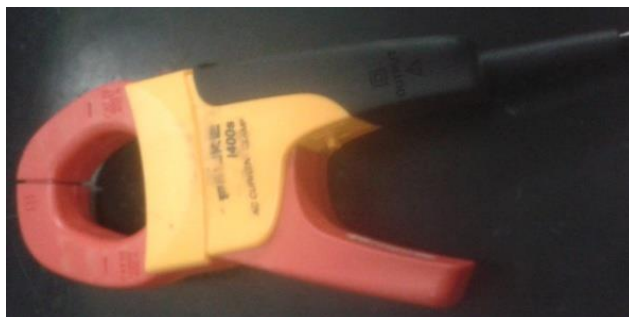
Figura 2. Pinza Amperimétrica Fuente: Elaboración propia
