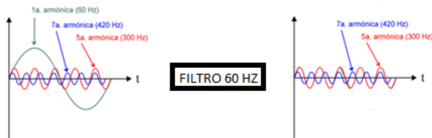
Figura 6 Filtrado de la componente fundamental
