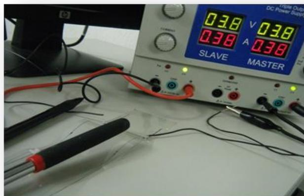
Figura 1. Corriente consumida por el alambre muscular de 150  $\mu\text{m}$
