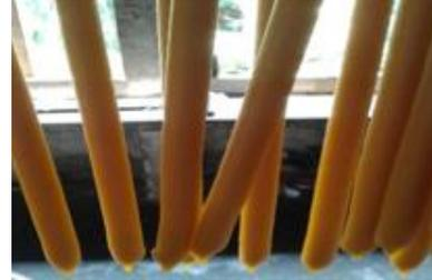
La cortadora a falta de mantenimiento como: ajustes de tornillo, lubricación de aceite en la cuchilla, afilado, etc., provoca que la vela al ser cortada no tenga cortes exactos o desproporcionadas.
