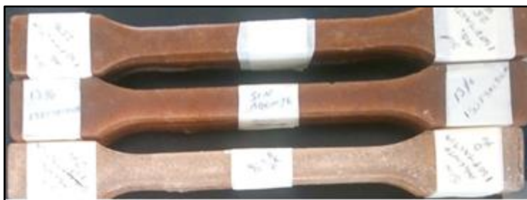
Figura 4. Probeta compuesto con 0%,13% y 25% de fibra de cáscara de naranja. Fuente: Elaboración propia
