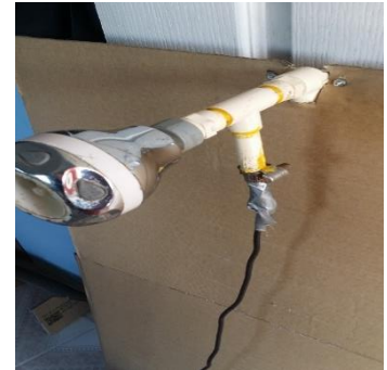
Figura 10: Sensor de temperatura instalado en la regadera Fuente: Elaboración propia (2020)
