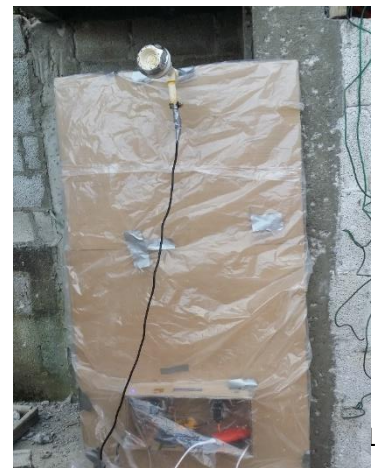
Figura 12: Prototipo instalado en la regadera Fuente: Elaboración propia (2020)
