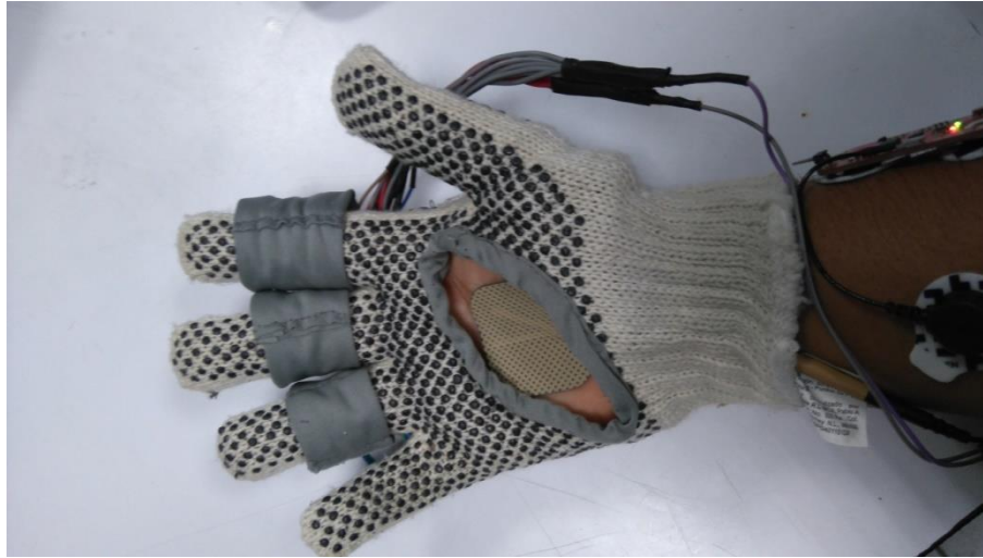
Ilustración 30. Producto Mínimo Viable. Colocación de electrodos para TENS. Parte inferior. (Fuente: Elaboracion propia)
